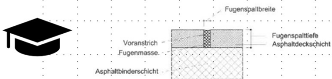
Bild 6: Anschlussfuge von Asphalt an Asphalt
