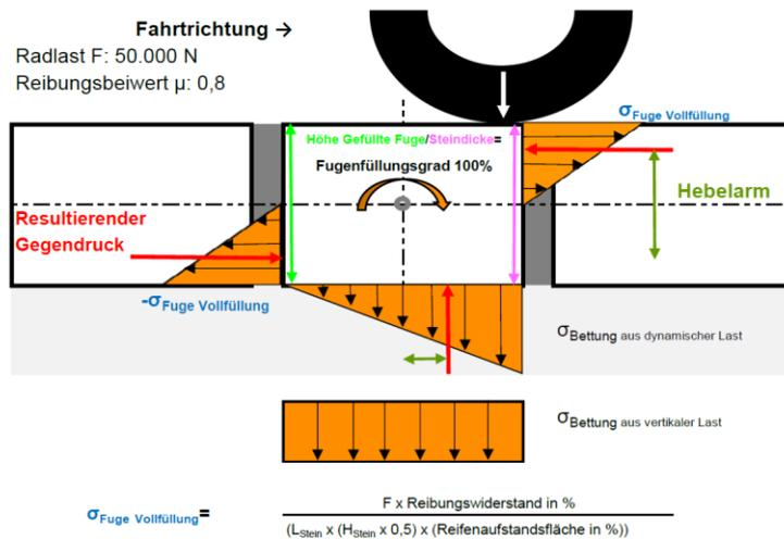
Druckspannungen bei Vollfüllung der Fugen und optimaler Lagerungsdichte
