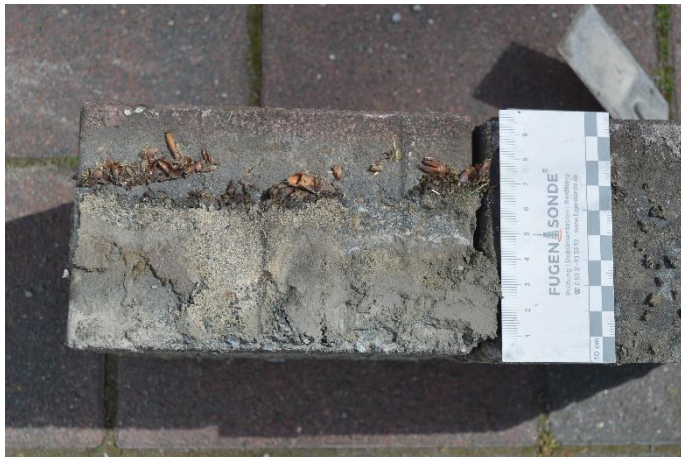
Beispiele 5: Busverkehrsfläche mit Fugen- und Bettungsmaterial nach ZTV und TL Pflaster
