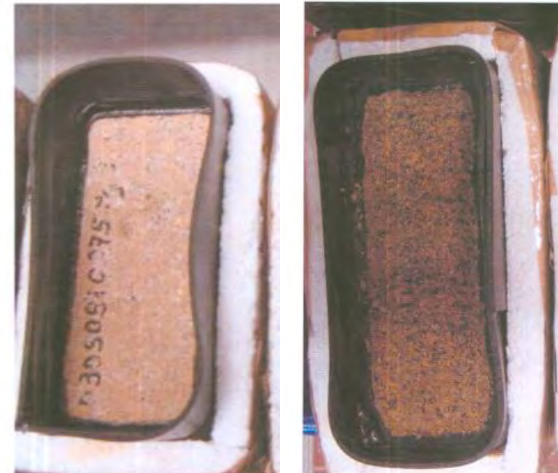
Intakte Betonsteinoberfläche nach der Prüfung
