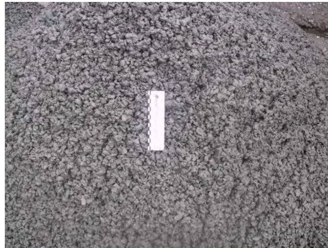
Konsistenz des Dränbetons
